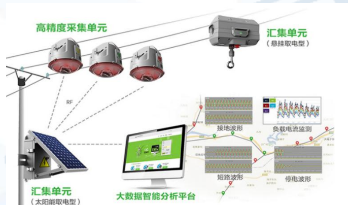
智能化配电网线路状态监测系统由三部分构成
